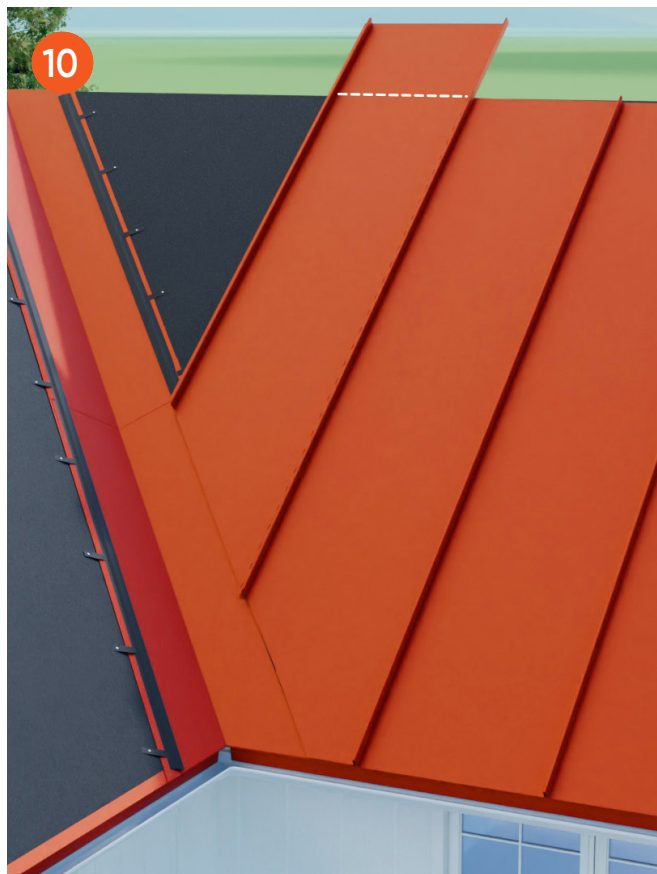
Placera plåten på taket och märk ut var den behöver kapas i överkant.
